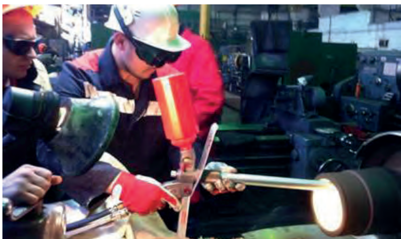
Напыление бронзовых втулок по технологии RotoTec FrixTec. Порошки: Proxon 51000, RotoTec19850. SSM10.
