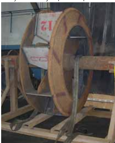
Ventilador con placa de desgaste contra polvo
