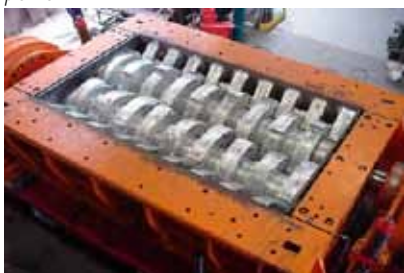
Desmenuzadora soldada con hilo tubular
