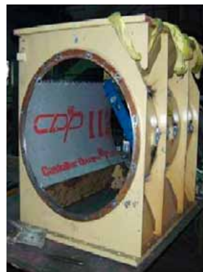
Válvula giratoria con placa de desgaste contra polvo
