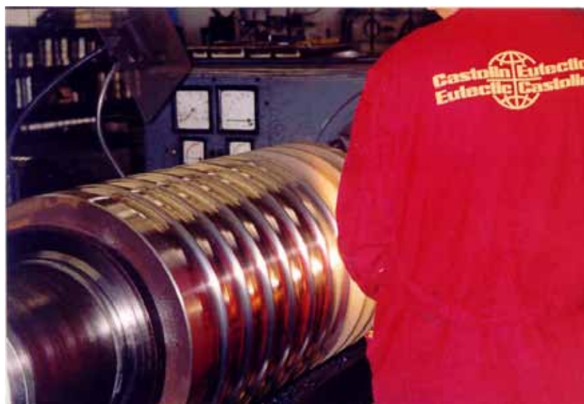
Tornillo con tratamiento de revestimiento en nuestros talleres
