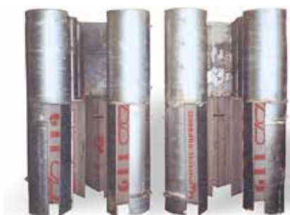
Cyklonrör i utloppsfilter från kraftverk
