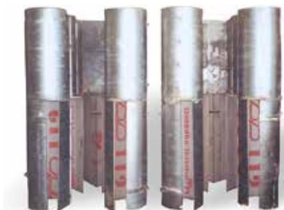
Tubes de cyclone dans le filtre d'échappement d'une centrale
