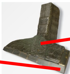
Ochranný návar proti opotřebení tloušťky 9-15 mm s mikrostrukturou bohatou na rovnoměrně rozptýlené komplexní karbidy chromu a niobu (tvrdost 62 HRC).
