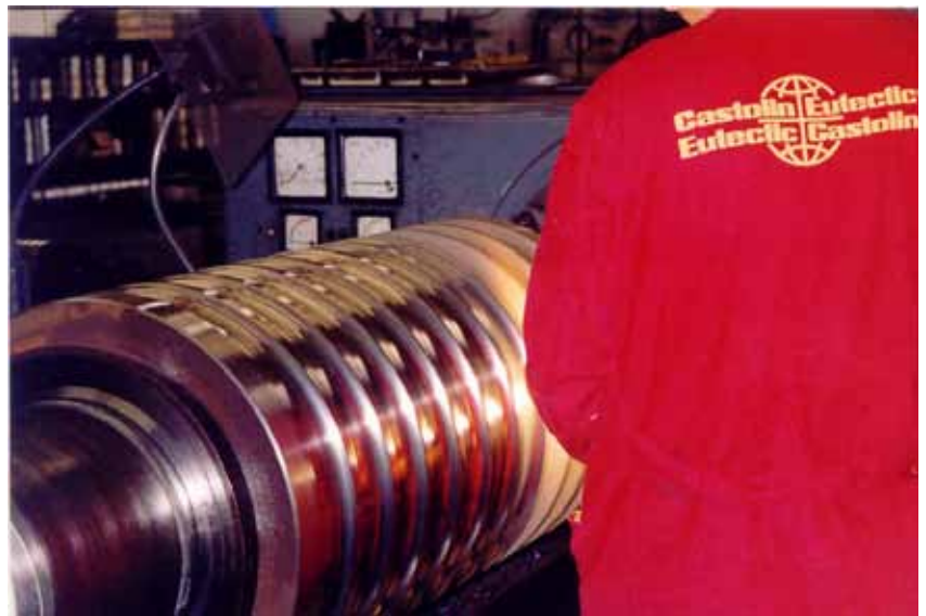
Verschleißbeschichtung einer Schnecke in unserer Werkstatt
