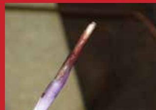
Рисунок 6: Подгорание флюсового покрытия прутка конкурента
