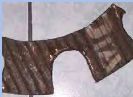
Aspas de revolvedora de arena silica
