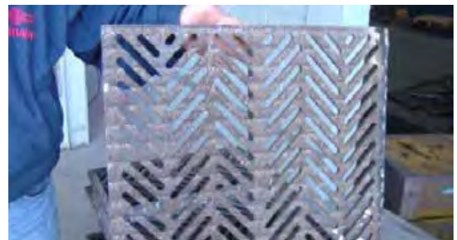
Cribas fabricadas con ED 1000 y cortadas con chorro de agua
