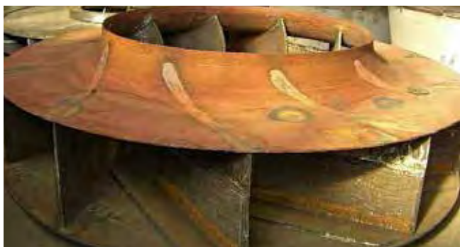
Ventilador con alabes diseñadas con ED 3000
