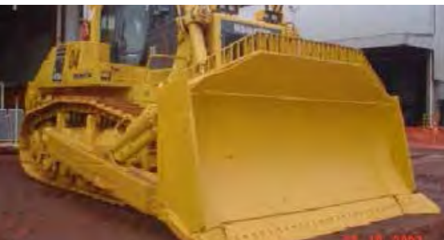
Pala de un komatsu blindado con placa ED 1000
