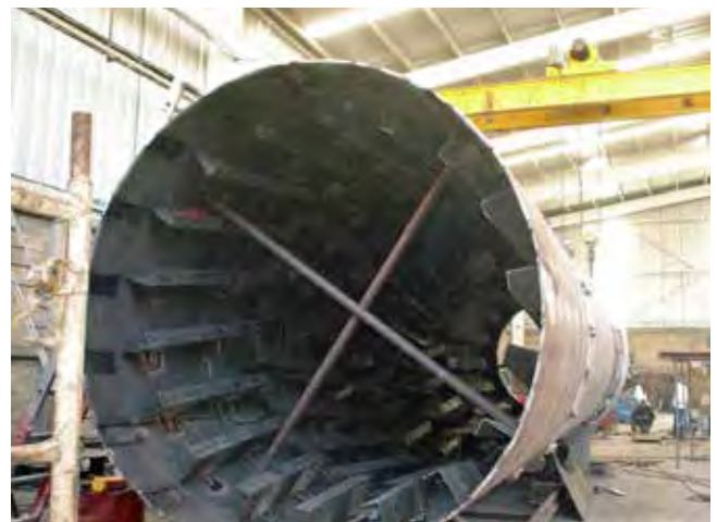
Rastras de un tambor secador de asfalto unidas a la estructura
