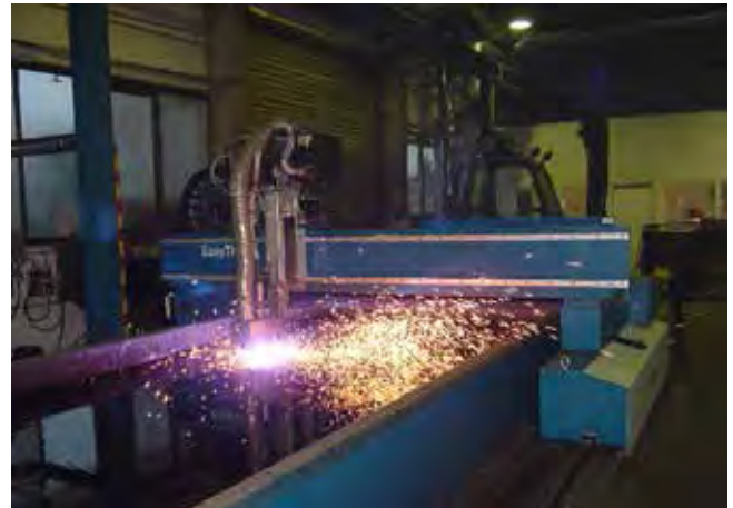
Las CDP® se pueden cortar con plasma, chorro de agua o laser
