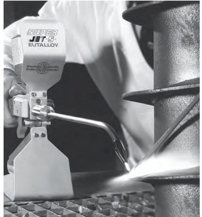
Anwendung des Eutalloy®-Verfahrens in Kombination mit einem Zusatzstab zum Panzern einer Förderschnecke
