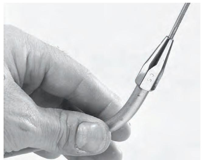
Säuberung der Flammspritzdüse mittels Düsenreiniger
