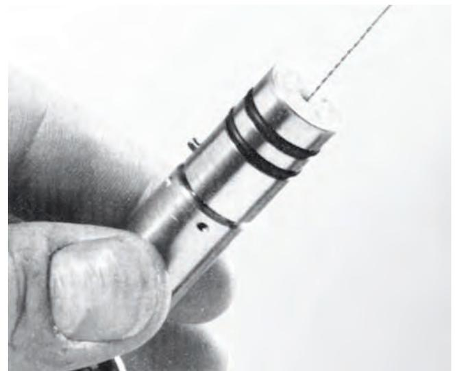
Sollte das Pulverventil nicht funktionieren, ist zu prüfen, ob die Pulverzufuhr verstopft ist (bei herunter gedrücktem Pulverzufuhrhebel - siehe Zeichnung)
