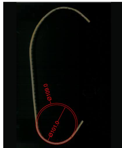
Diamètre intérieur minimum Di=100mm
