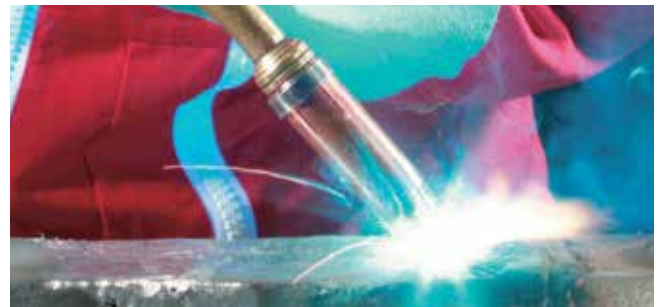
1) Boquilla de gas - 2) Tubo de contacto 3) Hilo macizo / tubular - 4) Gas protector - 5) Arco 6) Baño de soldadura - 7) Metal de soldadura - 8) Metal base
