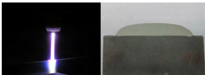
Сфокусированная плазменная дуга, снижает растворение наплавляемого металла, улучшает качество покрытия, не дает брызг при сварке, тем самым повышая качество и снижая стоимость работ по сварке и наплавке
