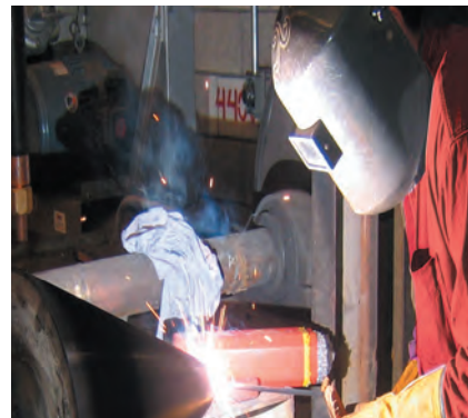
Este electrodo EutecTrode TeroCote conforma un depósito que proporciona protección eficaz contra la abrasión, la erosión y la corrosión, y es ideal para tornillos de transporte de gran duración.
