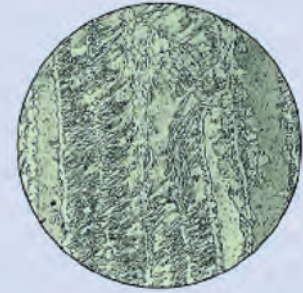
Estructura típica en columnas de un cordón de soldadura tipo 29-9 WS 312, susceptible de sufrir fracturas sometido a cargas mucho más bajas (x 120).
