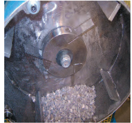
Máquina exclusiva para el ensayo de desgaste
