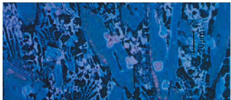
Microestructura de carburos complejos
