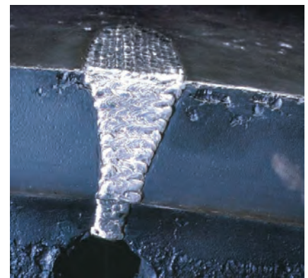
Un bajo aporte térmico consigue que nuestros electrodos EutecTrode minimicen las tensiones residuales al preconformar grandes soldaduras como las necesarias para reparar hornos de cemento fisurados.
