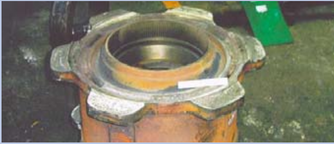
Moyeu de roue surfacé avec le DO*23
