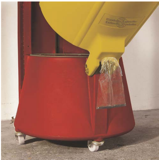
Rysunek | 1: Usuwanie pyłów z filtra do worka foliowego
