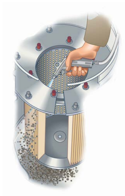
Rysunek | 2: Schemat usuwania pyłów sprężonym powietrzem
