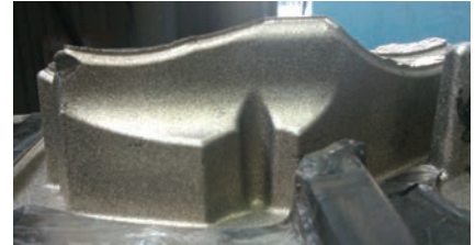
Fácilmente mecanizable con herramientas de corte estándar y mecanizado por electroerosión
