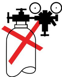
El proceso TeroMatec no requiere costosas inversiones ni una manipulación complicada de pesadas botellas de gas, reguladores, caudalímetros, mezcladores, mangueras, etc. El arco periférico autónomo autoprotegido TeroMatec está diseñado para su uso en exteriores cuando las condiciones de viento o corrientes del emplazamiento provocarían la desaparición del gas protector externo (GMAW) provocando soldaduras porosas y defectuosas.
