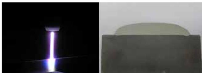
El arco de plasma concentrado ofrece un control adicional que se traduce en una reducida dilución, unos revestimientos de superficie lisa y cordones de soldadura sin salpicaduras: se minimizan los costes de reprocesado y material de soldadura.
