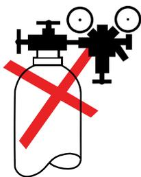
Ce procédé utilise des équipements qui s'adaptent aussi bien à l'intérieur qu'à l'extérieur, sans risque de diminution de la protection gazeuse de la zone à revêtir, même avec des vents de l'ordre de 50 km/h. En effet, l'absence d'un gaz protecteur supplémentaire rend inutile la présence d'un détendeur, d'un débitmètre et supprime le risque de givrage lors de la vaporisation et de la détente du CO<sub>2</sub>.
