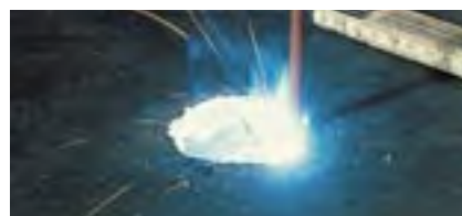
Découpe d'une ouverture avec une électrode CutTrode.
