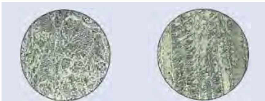
Microstructure d'une soudure Xuper 680S avec des grains d'austénite / de ferrite rapprochés et interconnectés garantissant une forte résistance aux fissures (x120).
