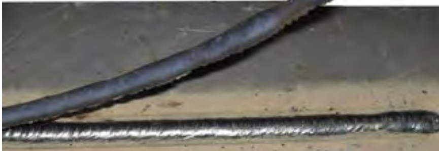
Le laitier se détache automatiquement après l'opération de soudage
