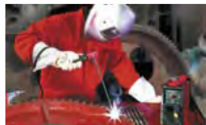
Reconstruction de dents d'une couronne d'engrenage.
