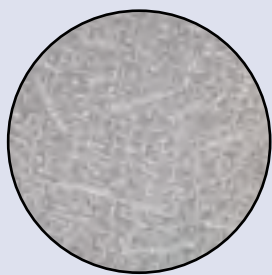
Microstructure de la XHD 6395N avec de nombreuses phases dures complexes réparties uniformément dans une matrice NanoAlloy. Cela procure une protection optimale contre une usure des plus intenses en termes d'abrasion et d'érosion (x300).
