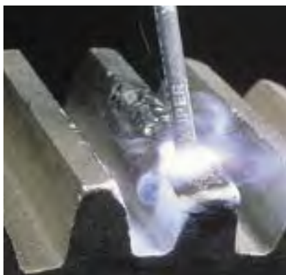
Réparation d'une fonte défectueuse
