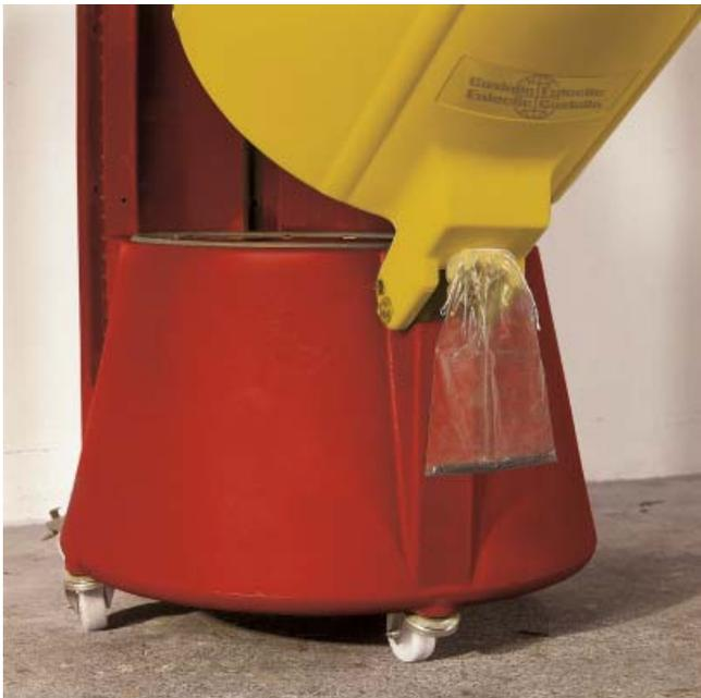
Detail-Darstellung der staubfreien Entleerung der Filterrückstände
