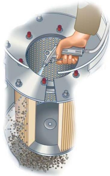
Detail-Darstellung der staubfreien Abreinigung des Filters mit Pressluft
