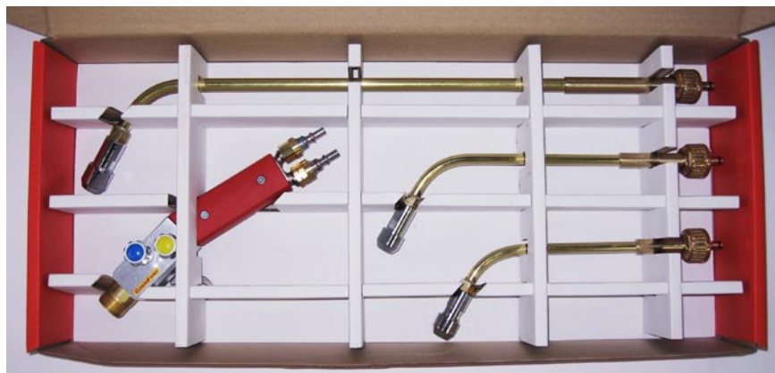
Das CastoFuse-Kompletzset besteht aus einem Griffstück mit drei Einschmelzbrennern, Größen 20, 30 und 40. Die drei Brenner ermöglichen verschiedene Flammenleistungen, so dass Werkstücke verschiedener Masse oder Dicke vorgewärmt und auf die Einschmelztemperatur aufgeheizt werden können.
