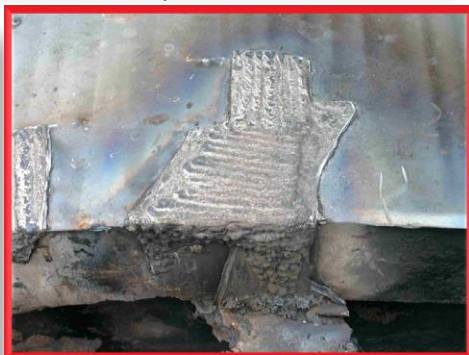
Ремонт трещины моста самосвала
