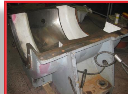
Ремонт трещины в чугунном корпусе
