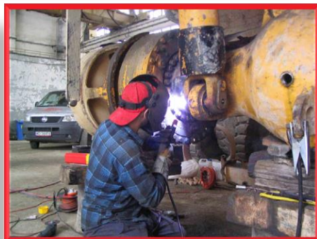
Ремонт трещины моста самосвала
