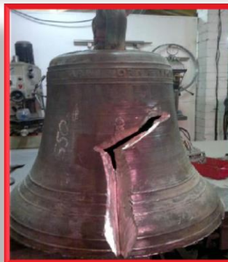
Ремонт трещины в колоколе
