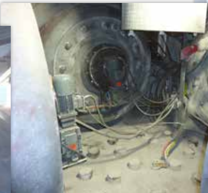
Polysius Quadropol, 4 Rollen und Mahlteller gleichzeitig geschweißt
