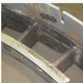
Düsenring-Segmente mit NanoAlloy-Verschleißschutz
