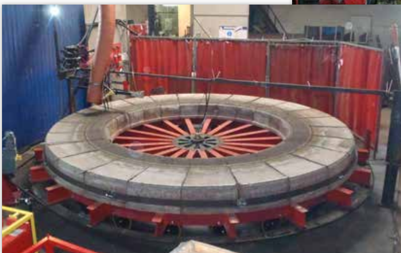
Regenerieren von Mahlteller-Segmenten bis zu 50 t Gesamtgewicht
