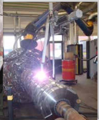
Brecher mit PTA-Verschleißschutzpanzerung
