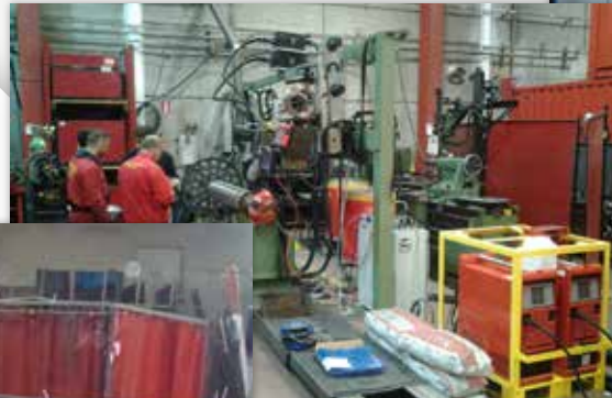
Automatisiertes Schweißen einer Strangußwalze
