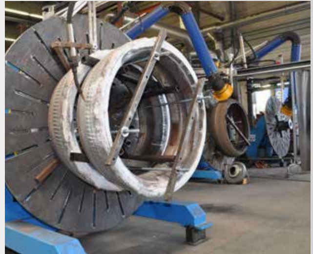
Drehvorrichtungen zum Schweißen von Bandagen
