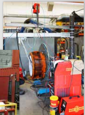
Beschichten mittels PTA-Schweißen
