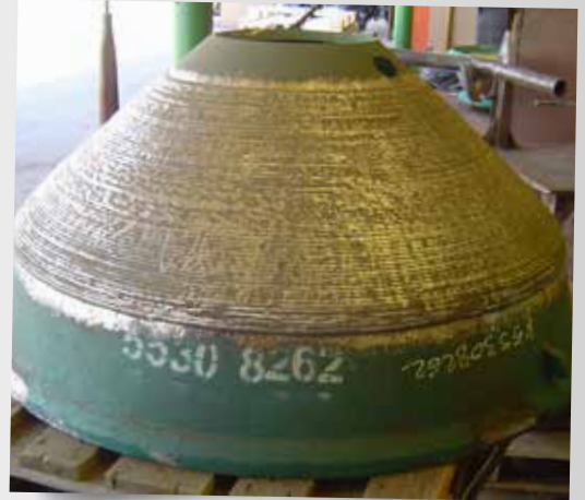
Vorbeugender Verschleißschutz an einem Kegelmischer
