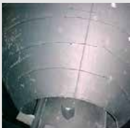
Vertikalmühle für Schlacke mit CDP®-Verschleißschutz
