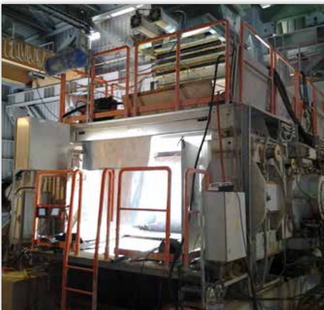
Vor-Ort-Reparatur einer Gutbett-Walzenmühle
