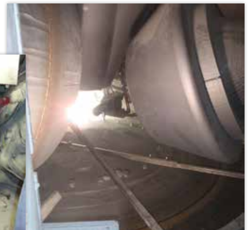
Мельница Loesche LM 46.2+2, одновременная наплавка 2 роликов и стола
