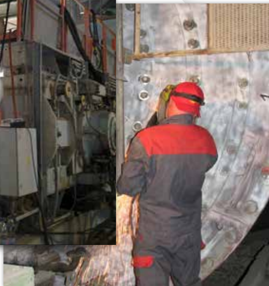
Ремонт трещин шаровой мельницы
