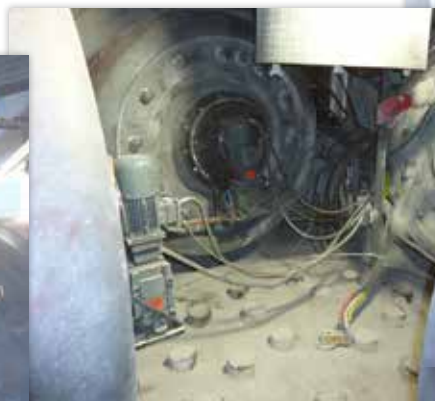
Мельница Polysius, одновременная наплавка 4 роликов и стола
