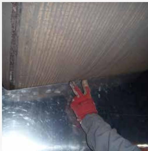
Contrôle des profils soudés sur un broyeur de finition Loesche
