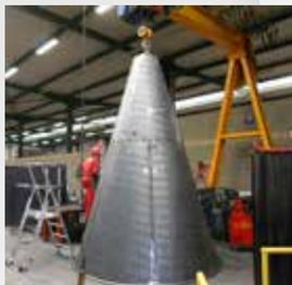
Réparation avec CDP® d'un cône de broyeur à charbon
