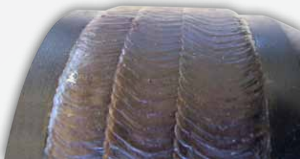
OTW 10SS liga hardbanding aplicada em um "Tool-Joint"
