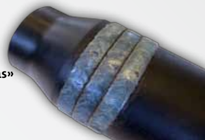
OTW 12Ti liga hardbanding aplicada em um "Tool-Joint"
