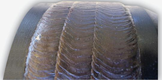
Alliage de hardbanding OTW 10SS appliqué sur un raccord de tige
