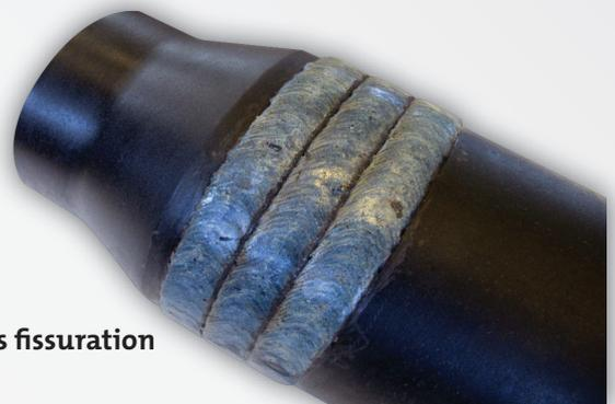
Alliage de hardbanding OTW 12Ti appliqué sur un raccord de tige
