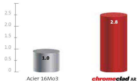
En utilisant des particules de quartz avec un angle d'impact de 30° à 550 °C.
