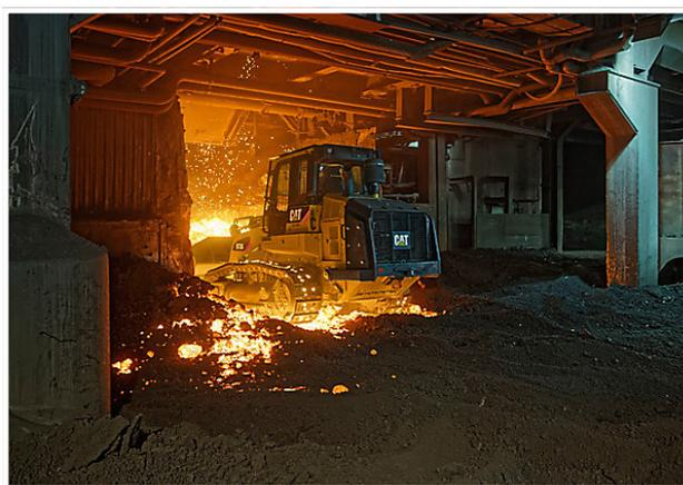
*FAR 30974 – Baggerschaufelzubehör im Heißbereich, verschleißgeschützt mit EnDOftec DO\*390N. EcoTest verfügbar*
