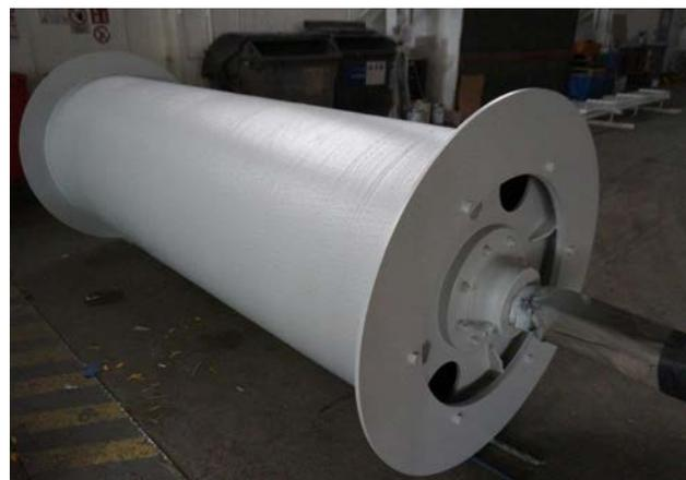
Trommel nach Verschleißschutz mit TeroMatec 4666
