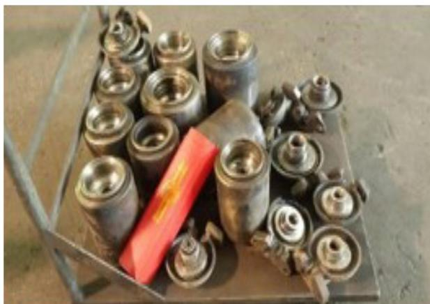
Ausbau der Rollen vor der Instandsetzung
