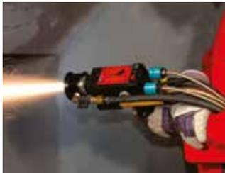
El ArcJet se acopla a la pistola para inyectar aire frente a la boquilla. El ArcJet delimita el patrón de proyección, reduciendo las sobreproyecciones y permitiendo el trabajo en espacios más cerrados, como ranuras profundas. Esto permite obtener mejoras significativas en la eficiencia del aporte, particularmente en componentes de pequeño diámetro.
