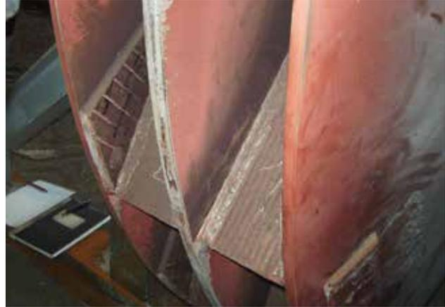
FAR 30645 – Álabes de ventilador en una planta de sinterización
