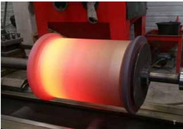
Rodillos recargados mediante proyección térmica en dos pasos
