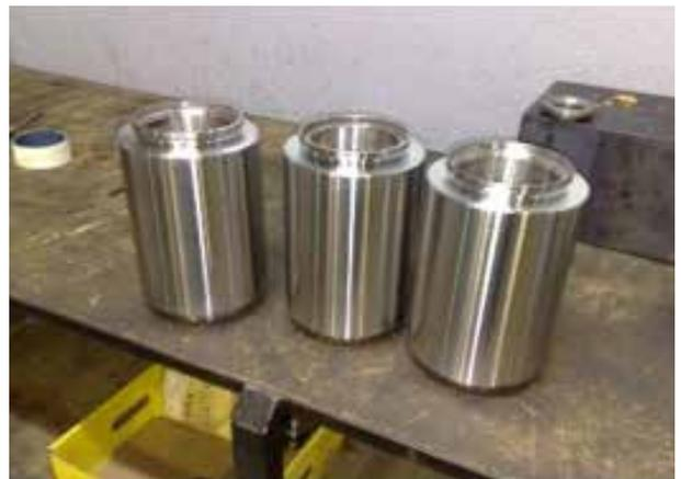
Rodillos tras recarga antidesgaste y mecanizado
